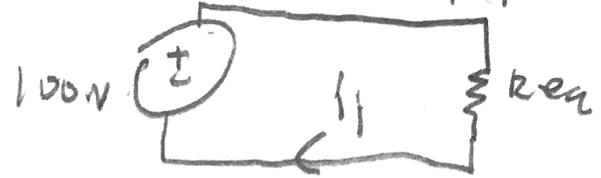
$R_{eq} = R_1 + R_2 // R_3 + R_4$
