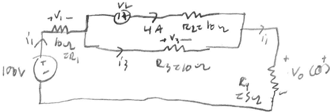
By KCL:  $-i_1 + i_3 + 4A = 0 \Rightarrow i_2 = i_3 + 4A$
