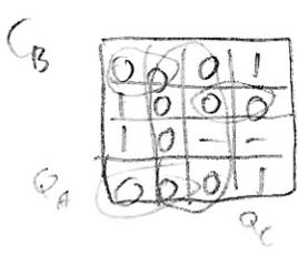
$$C_B = (X') (Q_C' + Q_B' + Q_A') (Q_B + Q_C + Q_A') (Q_A + Q_B + Q_C')$$
