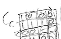
$$C_C = (X + Q_A' + Q_B') (Q_B' + Q_A) (X' + Q_C) (Q_B + Q_A) (X' + Q_A)$$
