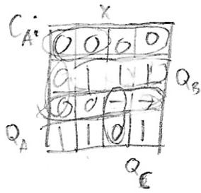
$$C_A = (Q_B' + Q_A') (Q_B' + Q_A') (Q_C' + X' + Q_B) (Q_A + X + Q_C)$$
