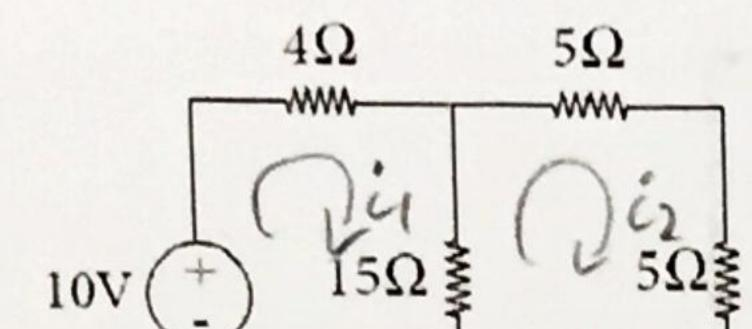
$10V - 4c_1 - 15C_{c_1} - c_2) = 0$  $(2) - 5i_2 - 15(i_2 - i_1) - 5i_2 = 0$  $O = 10V - 19i_1 + 15i_2 = 0$  $19'_{1} - 15'_{2} = 10$ @ - 5i2 - 15i2 + 15i1 - Si2 = 0  $-25i_{2}+15i_{1}=0$  $15i_1 = 25i_2 \rightarrow 3i_1 = 5i_2 \rightarrow \frac{3}{5}i_1 = i_2$  $019i_1 - 15(\frac{3}{5}i_1) = 10$ 192 - 92 = 10 $10i_1 = 10 \rightarrow i_1 = 1A$  $(2) \cdot \zeta_2 = \frac{3}{5} \cdot \zeta_1 = \frac{3}{5} \cdot A$  $P_{15n} = I^2 R = (i_1 - i_2)^2 / 5n$
