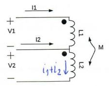
$$V_{1} = L_{1} \frac{di_{1}}{dt} + M \frac{d(i_{1}+i_{2})}{dt}$$
