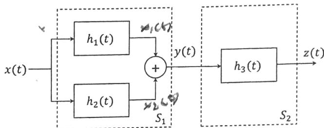
where  $h_1(t) = \delta(t-1)$ ,  $h_2(t) = \delta(t-2)$ , and  $h_3(t) = \delta(t-1) - \delta(t-2) + \delta(t-3)$ .
